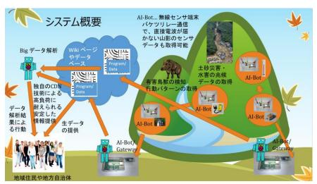
の研究を行っています。里山のあちこちで、その場所の照度・温度・湿度・気圧・地磁気・加速度・音・近くの動物の動き・位置・時間等を入手し、Wiki (ブラウザで簡単に編集することができる Webページ) のページに、それらのデータを書き込みます。このデータを蓄積し、人工知能を使って、過去に発生した災害と照らし合わせることにより、災害の予兆を検知しようとしています。また、無線センサネットワーク端末にデータ転送機能を付けることにより、電波が直接届かない場所でも、データの収集を可能にします。
